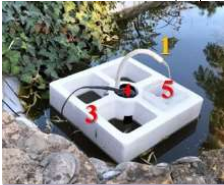
Рис. 9. Модель автономного мобільного аератора з можливістю подальшого фільтрування води
