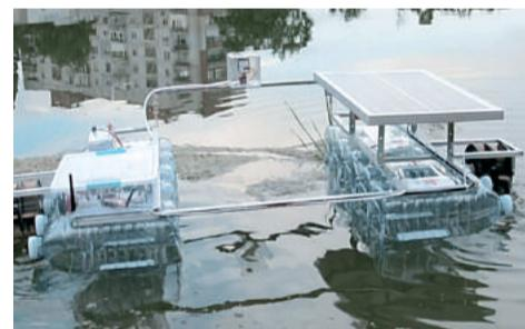
У 17-річного Руслана Коптєва з Кропивницького було трохи пластикових пляшок, сонячна батарея, пару гвинтів і GPS-навігатор. З усього цього він примудрився створити робота, який очищує річки від сміття. Ім'я йому Riveroni.
