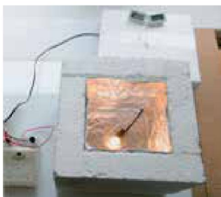
Рис. 1.7. Андрій Семененко – переможець міжнародних конкурсів (а) та його винахід «Пристрій для вимірювання коефіцієнту теплопровідності теплоізоляційних матеріалів» (б)
