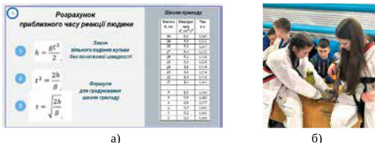
Рис. 1.11. Навчально-ігровий прилад для вимірювання часу реакції спортсменів: а) теоретична основа пристрою; б) його використання в секції з тхеквондо
