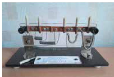
а) б) Рис. 1.12. Демонстраційний магазин опорів: а) схема пристрою; б) його діюча модель
