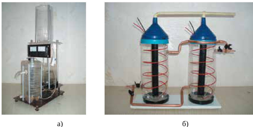
Рис. 1.5. Установка для очистки стічних вод (патент України № 11039U): а) макет; б) діюча модель
