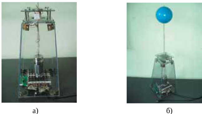
Рис. 2.5. Експериментальний зразок анемометра (патент України № 43782 [2]):
