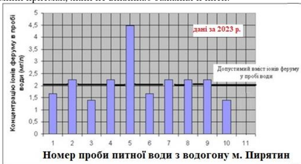
Рис. 2.7. Порівняння показників концентрації йонів Феруму в пробі води (мг/л)
