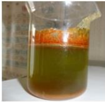
Рис. 2.4. Окисненням феруму (II) гідроксиду до феруму (III) гідроксиду і розчинення його в хлоридній кислоті з утворенням комплексу
